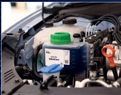
**ValveCare-3 ist ein elektronisch gesteuertes Dosiersystem für Benzinmotoren, die auf LPG oder CNG umgerüstet wurden. Zusammen mit dem Prins ValveCare-Additiv trägt das System dazu bei, die Brennkammer sauberer zu halten und den Verschleiß von Ventilen, Ventilsitzen und Benzineinspritzdüsen zu reduzieren.**
